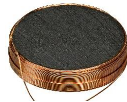
Empfängerspule, Ø8,5mm, Höhe 2,0mm
