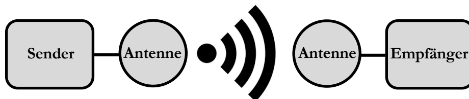
Bild 1 – Grundlegender Aufbau eines Induktiven Energie-Übertragungssystems
