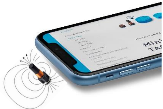
Bild 9: NFC-Lesevorgang mit Smartphone
