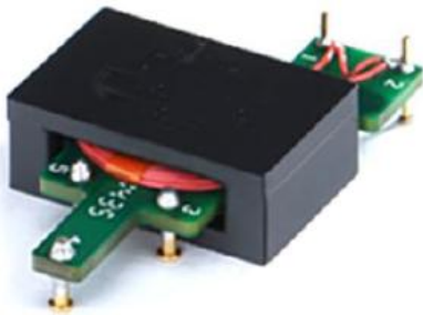
Image 4 : Transformateur planar avec enroulements constitués de circuits imprimés et de bobines de fil
