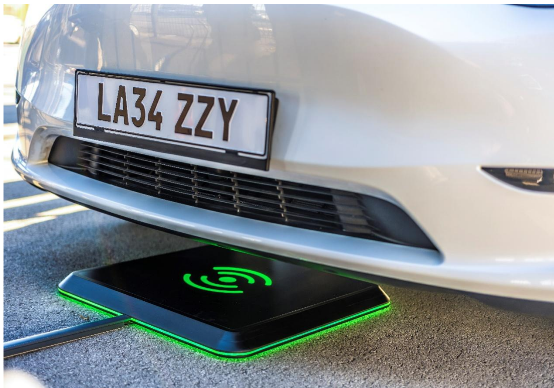
Image 1 : recharge inductive d'une voiture particulière
