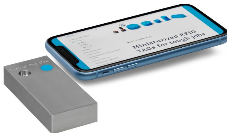
Figure 1 : Exemple d'application : lecture d'un NeoTAG® Plug MFG10340 au moyen d'un smartphone compatible NFC.
